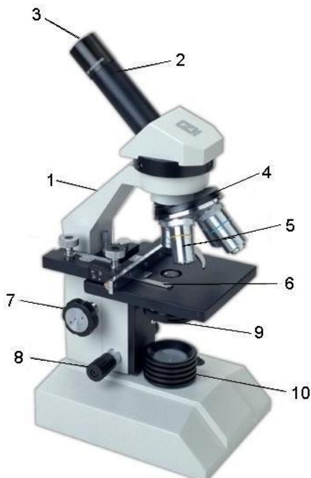
Рисунок 1 – Схема микроскопа: 1 – штатив; 2 – тубус; 3 – окуляр; 4 – револьверное устройство; 5 – объектив; 6 – предметный столик; 7 – макровинт; 8 – микровинт; 9 – конденсор; 10 – осветительный аппарат
